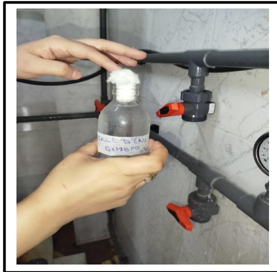
Figure 21 : Prélèvement d'eau au point de sortie après l'osmoseur (eau osmosée) de système Gambro ( Photo prise par Mallem et Aouaichia )
