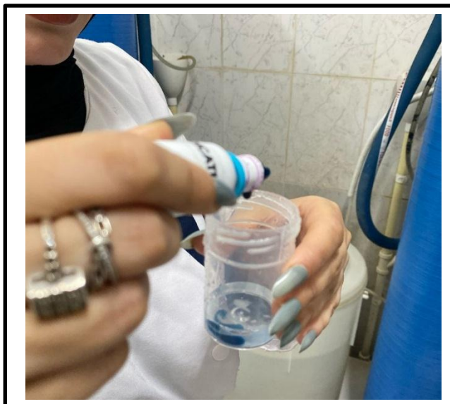
Figure 18 : Une photo démonstrative de la méthode du test qualitatif de dureté (Photo prise par Mallem et Aouaichia )
